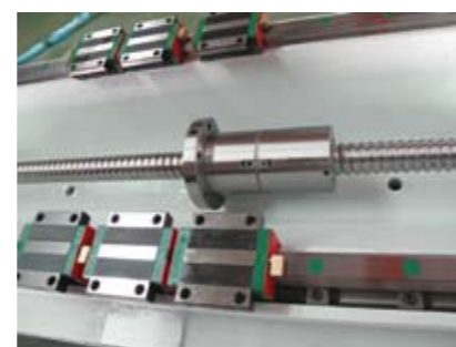
Linear Way X, Y, Box Way Z
